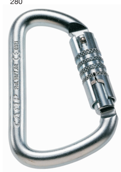
Автоматическая защёлка требуется три движения: приподнять, повернуть и открыть
